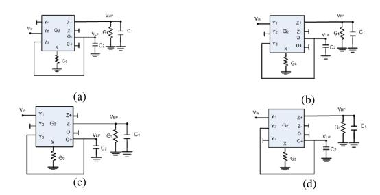
Fig. 12. DDCCTA-TT Realizations(a) Class A (b) Class B (c) Class C (d) Class D
